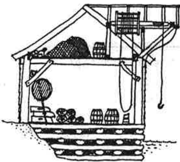
Skjematisk snitt gjennom sjøbu bygt på bolverk ut i sjøen. Vinda i vindskuret er opplagra på vindebommen og vert dreven med tauverk og muskelkraft.
